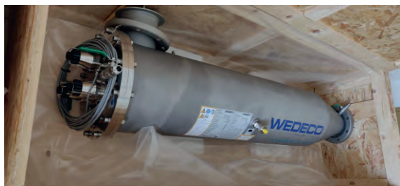
Die UV-Desinfektionsanlage vor dem Einbau
