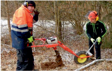
Arbeiten mit dem Motorenerdbohrerät
