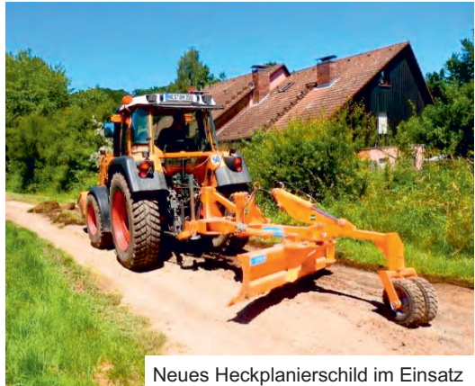
Neues Heckplanierschild im Einsatz
